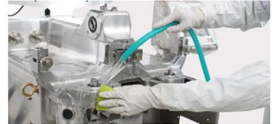
Füllzylinder aus rostfreiem Stahl
