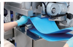
Förderbänder sowie andere Ersatzteile können mühelos ein- und ausgebaut werden
